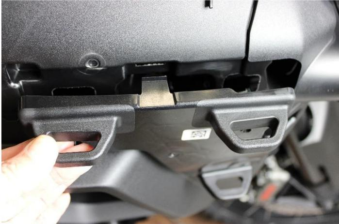
Entfernen Sie die Aluminium Seitendeckel (3 Torx Schrauben) und entnehmen Sie die Ösen-Platte (wie im Bild). Die Kunststoffplatte mit den „Ösen“ wird für unsere Taschen nicht benötigt.
