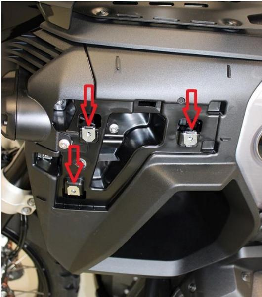
Anschaubpunkte des Aluminium Seitendeckels. Hier werden die Hornig Tankseitentaschen zusammen mit dem Alu-Seitendeckel verschraubt (3 Schrauben).
