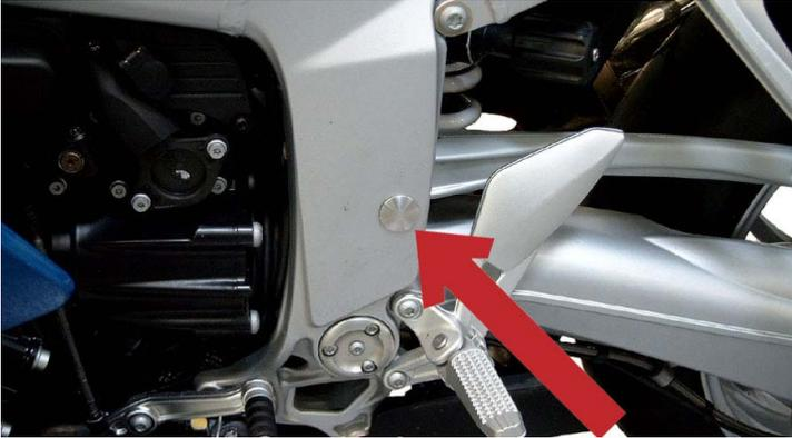
Couverture pour le trou au-dessus du bras oscillant de l'encadrement.
