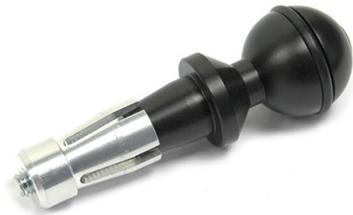
Prise pour les guidons BMW ayant un diamètre d'intérieur de 12-16mm. Insérez simplement la prise usinée CNC dans la partie ouverte du guidon (habituellement fermé avec une prise en plastique). La prise sera fixée grâce à une fermeture d'extension. Presque tout système de navigation peut être fixé sur la boule Ram de cette Fixation GPS.
