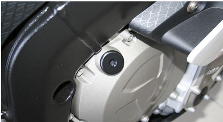
Ce bouchon de réservoir d'huile est fabriqué en aluminium de première qualité et disponible en noir anodisé et argent anodisé. Vous pouvez ouvrir ce bouchon du réservoir d'huile avec une Torx T45.
