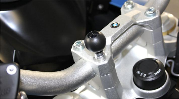
Vissez le support GPS sur la partie supérieure du té de fourche. La vis est longue de 55/60/65mm avec un filetage M8.
