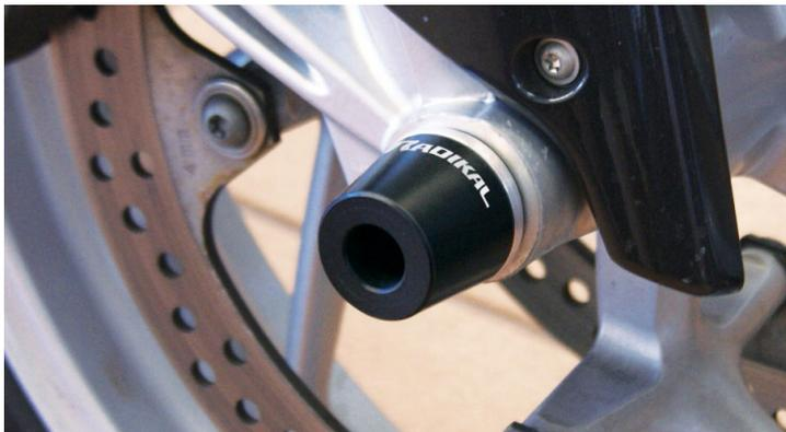
Cette protections de bras de fourche est faite en plastique latté cnc (POM). Le support est fait en cnc moulu et aluminium anodisé.
