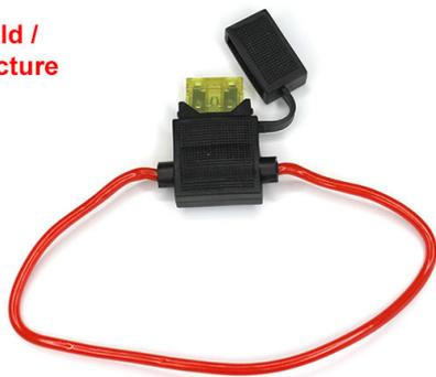
Ce porte-fusible inclut un fusible plat de 20A et peut être ajouté à un câble de rallonge d'un dispositif électrique, par exemple, des feux supplémentaires, GPS ou klaxons. Vous pouvez utiliser des fusibles à partir de 1A – 30A. Voltage nominal: 6-32V, Incluant un câble de 2,5mm<sup>2</sup>, capuchon de protection et protection contre eau répandue.
