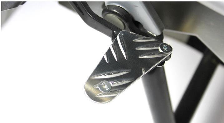
Cette pièce spéciale est faite en aluminium extrêmement maniable pour permettre un freinage sûr. Il est monté avec deux vis, l'u-vis, écrous et coques qui sont tous livrés avec l'Elargisseur.
