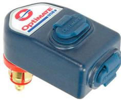
À l'aide de cet adaptateur il est possible de connecter des objets électroniques, qui ont besoin d'une prise USB, à la prise de bord d'une moto. Ainsi, on peut les y charger et opérer. L'adaptateur réduit le voltage de 12V au standard USB de 5V (3300 mA maximum). La spécificité de cet adaptateur est sa forme compacte qui inclut un angle de 90 degrés. Grâce à cet angle on peut bien mettre des câbles de charge aussi dans des prises de bord qui se trouvent sur le côté d'une moto.
