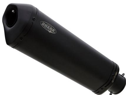
L'échappement slip-on SHARK DSX-10 convainc par son design pentagonal conique, mais aussi par son son puissant et agressif. L'échappement est fabriqué en acier inoxydable revêtu et sera fixé à l'aide d'un support à visser. Le db-killer de l'échappement est éliminable et le catalyseur d'origine est préservé en montant l'échappement.
