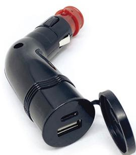
Notre Adaptateur USB pour la prise motocyclette (USB10) s'adapte aux différentes prises 12/24V à l'USB-Standard 5V à deux prises USB (USB-A et USB-C avec max. 3,6A chacune).. L'adaptateur USB habituel s'adapte uniquement à la grosse prise d'allume-cigare. Cet Adaptateur USB s'adapte aux deux: grosse prise d'allume-cigare et petite prise d'allume-cigare comme celle utilisée par BMW (prise DIN numéro d'article 90025).
