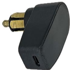
À l'aide de cet adaptateur il est possible de connecter des objets électroniques, qui ont besoin d'une prise USB-C, à la prise de bord d'une moto. Ainsi, on peut les y charger et opérer. L'adaptateur réduit le voltage de 12V au standard USB de 5V. La spécificité de cet adaptateur est sa forme compacte qui inclut un angle de 90 degrés. Grâce à cet angle on peut bien mettre des câbles de charge aussi dans des prises de bord qui se trouvent sur le côté d'une moto.
