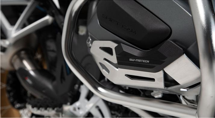
Cette protection de cylindre protège vos cylindres contre les chutes de pierres et contre des dommages à cause des chutes. Les couvercles sont spécialement adaptés à la forme des couvercles de soupape et sont équipés d'un insert en caoutchouc amortissant à l'intérieur. Le cadre de base en argent est fabriqué en aluminium gravé au laser et brossé. Le pad noir est fabriqué en aluminium usiné en CNC.
