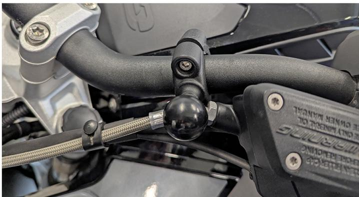
Ce support de base RAM Mounts avec boule (1 pouce) est idéal pour la fixation sur des guidons tubulaires d'un diamètre de 19,1 à 25,4 mm.
